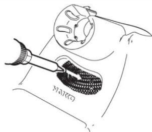
เศษวัตถุที่ไม่สามารถขัดออกง่ายๆ ด้วยฟองน้ำทำความสะอาดหรือ rubber cleaner นั้น สามารถขัดออกด้วยการใช้ cleaning wire
