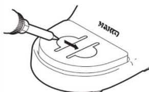
ขอให้ใช้ฟองน้ำทำความสะอาดที่มาพร้อมกับเครื่อง เพื่อทำความสะอาดปลายหัวแร้ง การใช้วิธีการที่หลอกหลอน นอกเหนือจากการขัดเศษลวดบัดกรีอย่างง่ายๆ จะถึงการขัดอย่างหนดจดอาจเป็นผลให้เกิดอีกด์ซึ่เดชั่นได้
